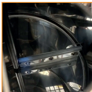
Asse con pale per agitazione e striscia in silicone
