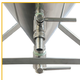
Valvola di prelievo e scarico totale
