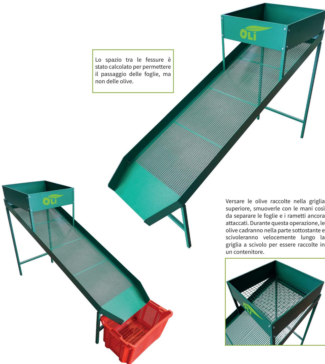
Versare le olive raccolte nella griglia superiore, smuoverle con le mani così da separare le foglie e i rametti ancora attaccati. Durante questa operazione, le olive cadranno nella parte sottostante e scivoleranno velocemente lungo la griglia a scivolo per essere raccolte in un contenitore.
