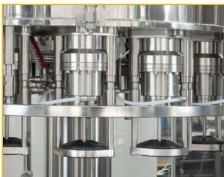
la riempitrice Compact 7.1 è una macchina elettropneumatica isobarica per riempimento dei prodotti carbonati in autoclave con l'entrata e l'uscita sullo stesso lato quindi utilizzabile anche da una sola persona.
