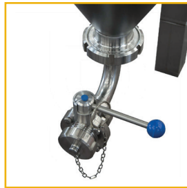
Absperrklappe Ventil für Total Ablass
