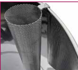
Gelochter Zylinder im Bottich integriert.
