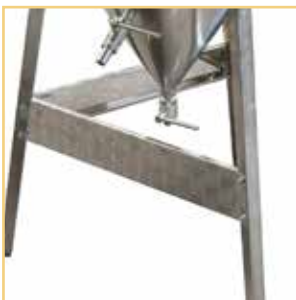
Probenahmeventil und Total Ablassventil
