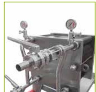
Sichtglas / Manometer / Entlüftungshähne
