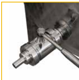
DIN 25 Ventile mit PG20
