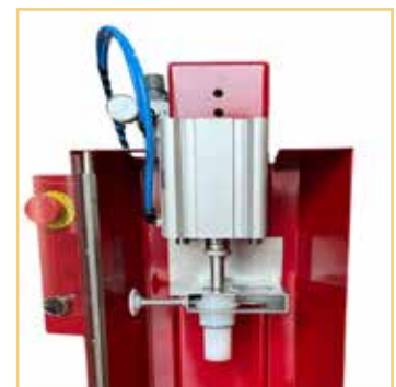
Kegel für die Einführung von bündigen Korken
