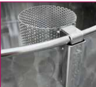
Gelochter Zylinder im Bottich integriert.
