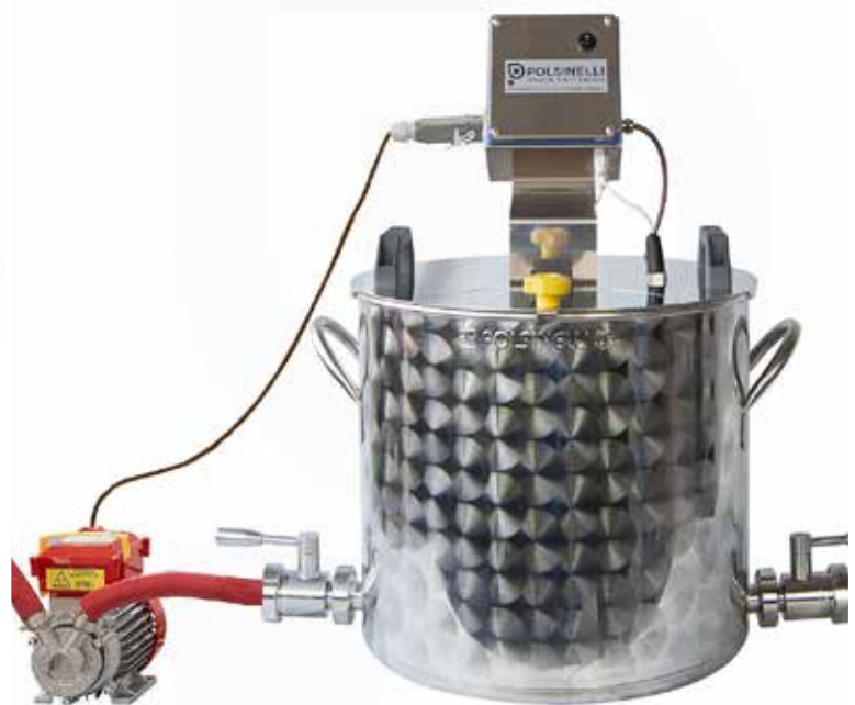
Elektronischer Grant mit Elektropumpe
