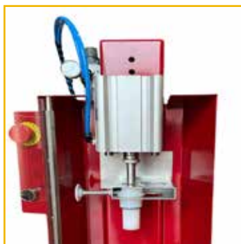
Cône d'insertion bouchon ras
