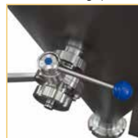
Vanne à papillon pour vidange partielle
