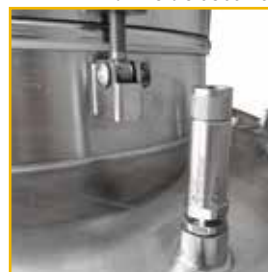
Vanne de sécurité
