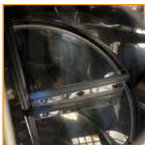
Tige avec pales pour agitation et bande en silicone
