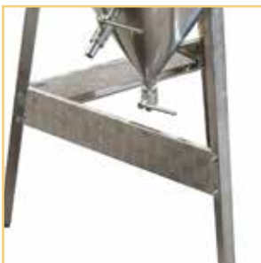
Vanne de prélèvement et de vidange totale
