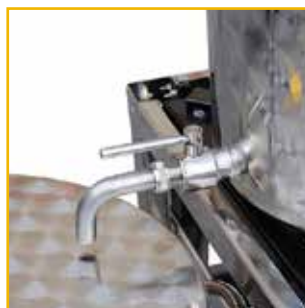
Vanne de sortie du moût
