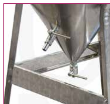
Vanne inox à bille avec raccord pour tuyau Ø 20 mm.
