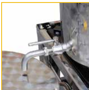
Vanne de sortie du moût
