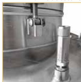
Vanne de sécurité
