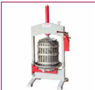
Modello Beta bacino girevole dotata di meccanismo idraulico manuale.
