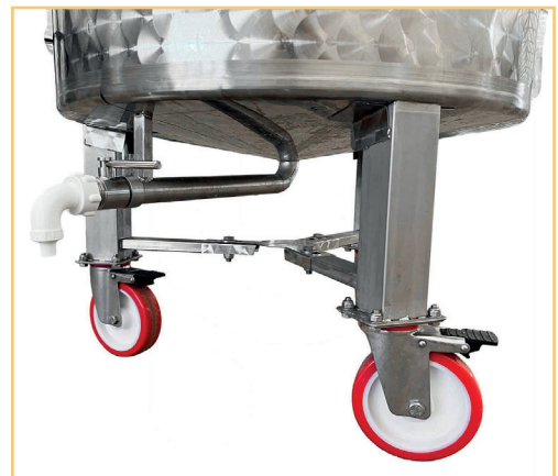
10° konischer Boden mit total Ablass komplett mit 1" x ENO30 Edelstahl Kugelhahn.
