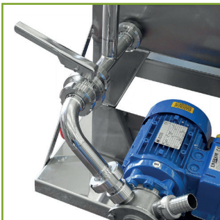
Vannes de régulation entrée/sortie
