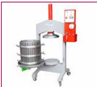
Modell Alfa mit herausnehmbarem Korb.
