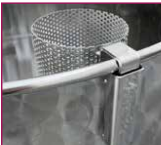
Gelochter Zylinder im Bottich integriert.
