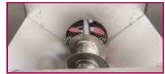
Trichterinnenraum mit Edelstahlschnecke.
