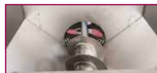
Intérieur trémie avec vis inox.
