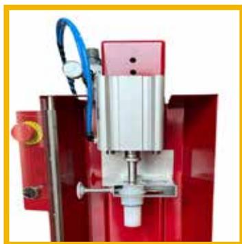
La tappatrice pneumatica **Starcap** è un dispositivo professionale per facilitare e velocizzare le fasi di tappatura delle bottiglie. La macchina svolge la funzione pneumatica per tappi in sughero, sintetici ed agglomerato fino alla misura di 24 x 45 mm, ma anche per tappi a corona della dimensione di 26 e 29 mm e di quelli in plastica.
