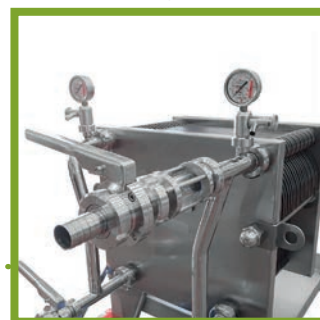
Specola visiva / Manometri Rubinetti spurgo aria
