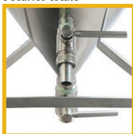
Valvola di prelievo e scarico totale
