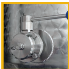
Valvola a farfalla per dry hopping
