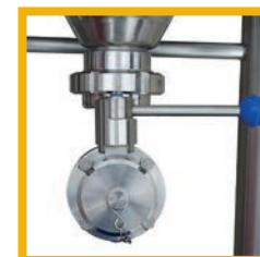
Valvola a farfalla per scarico totale
