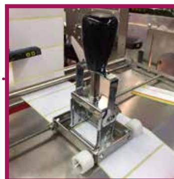
Timbratore posizionato sulla ETI05
