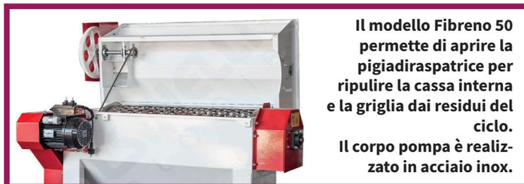
Il modello Fibreno 50 permette di aprire la pigiadiraspatrice per ripulire la cassa interna e la griglia dai residui del ciclo. Il corpo pompa è realizzato in acciaio inox.
