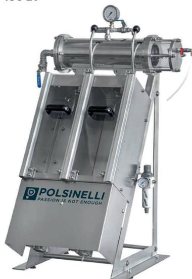
Riempitrici isobariche adatte al riempimento di bottiglie di tutti i formati. Realizzate in acciaio inox AISI 304 ricavato da unica piastra tagliata al laser, dotate di sollevamento automatico della bottiglia tramite pistone pneumatico.
