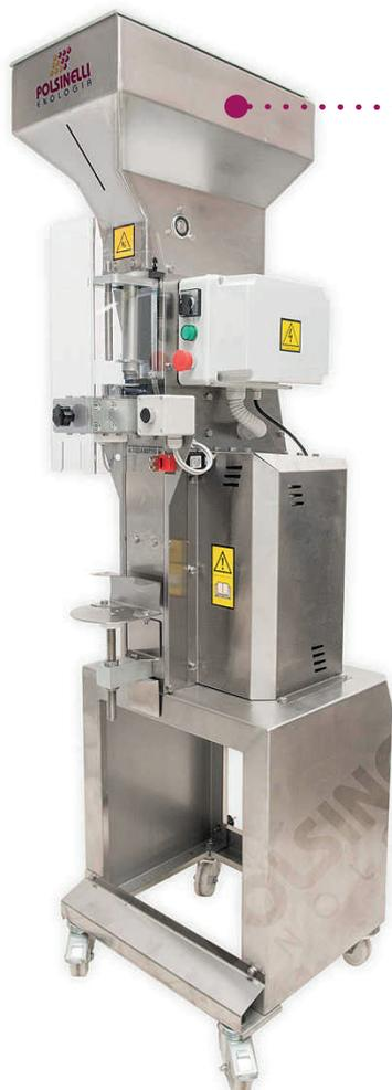
La tappatrice **P450** semiautomatica per tappi in sughero è un prodotto di qualità professionale progettato per facilitare e ottimizzare le fasi di tappatura delle bottiglie. Fabbricato in acciaio inox AISI 304, questo modello assicura una perfetta stabilità chimica e un rispetto ottimale delle qualità organolettiche dei liquidi alimentari processati. Integra blocchetti inox e funziona tramite l'allacciamento a corrente da 220V oppure da 380V (su richiesta).
