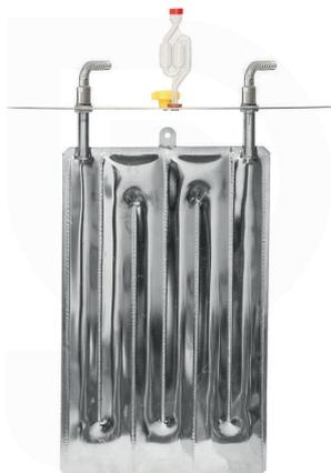
Completi di flangia inox spessore 20/10 mm con gorgogliatore, piastra inox refrigerante ad immersione, pomello e curve inox con connessioni 1/2" M + PG20.
