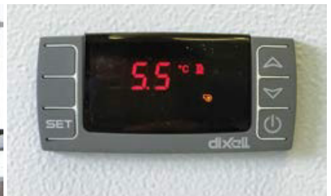
Centralina elettronica XR60CX con display digitale integrato ad icone.
